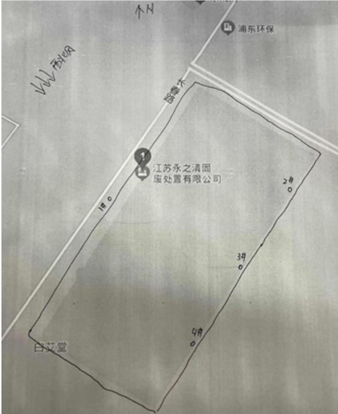
“○”表示无组织废气检测点
